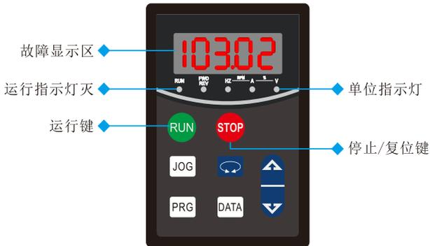
图7-2 故障记录界面LED显示举例
